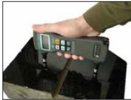
Medir el tiempo de tránsito ( t_c ) a través de la grieta
