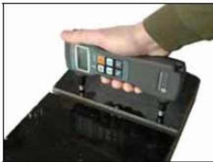
Medir el tiempo de tránsito ( t_p ) Paralelo a la grieta
