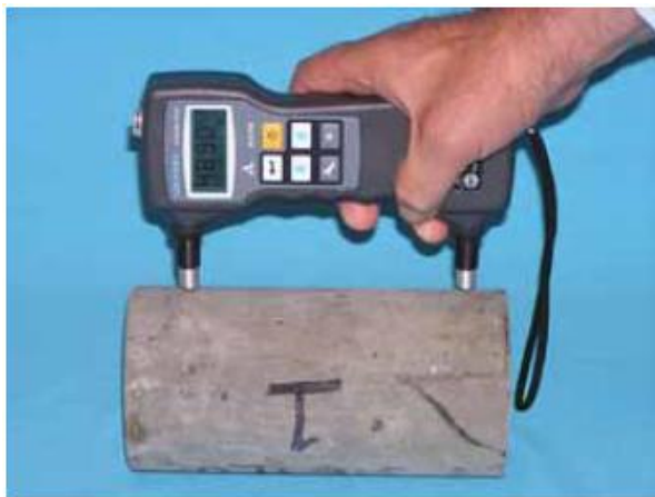
Medir el tiempo de tránsito ( t_p ) Paralelo a la grieta
